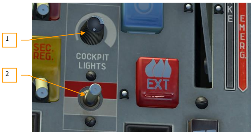
Abbildung 91: Bedienelemente für das Beleuchtungssystem im vorderen und hinteren Cockpit
