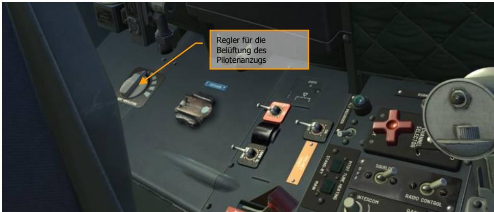
Abbildung 60: Regler für die Belüftung des Pilotenanzugs
