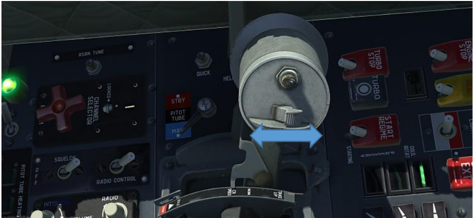
Abbildung 49: Fahrwerkshebel, vorderes Cockpit49
