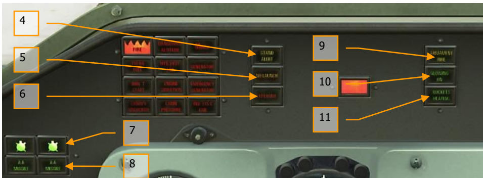
Abbildung 157: Die Bedienungen und Signalleuchten der Bombenausrüstung im hinteren Cockpit
