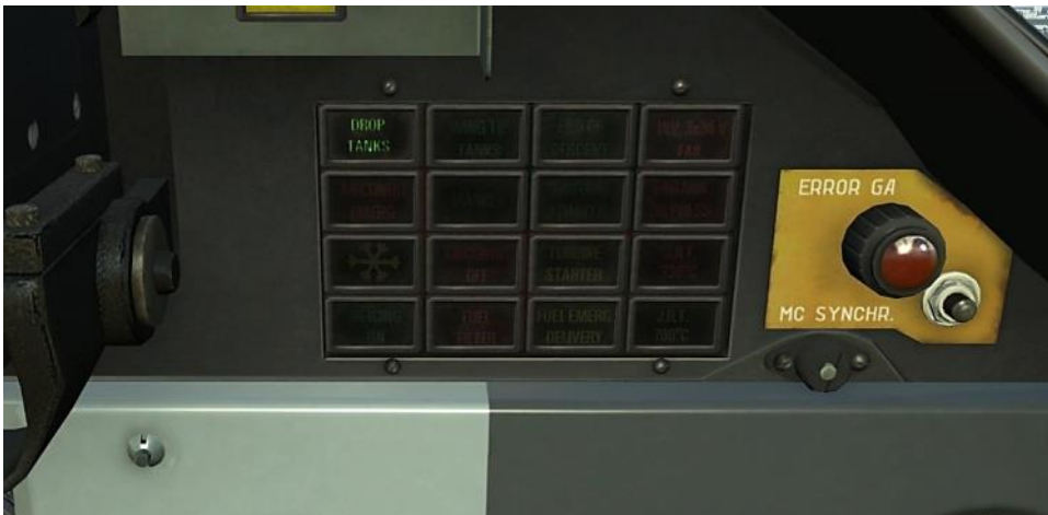
Abbildung 174: Die Leuchte: DROP TANKS auf dem Signalleuchtenfeld
