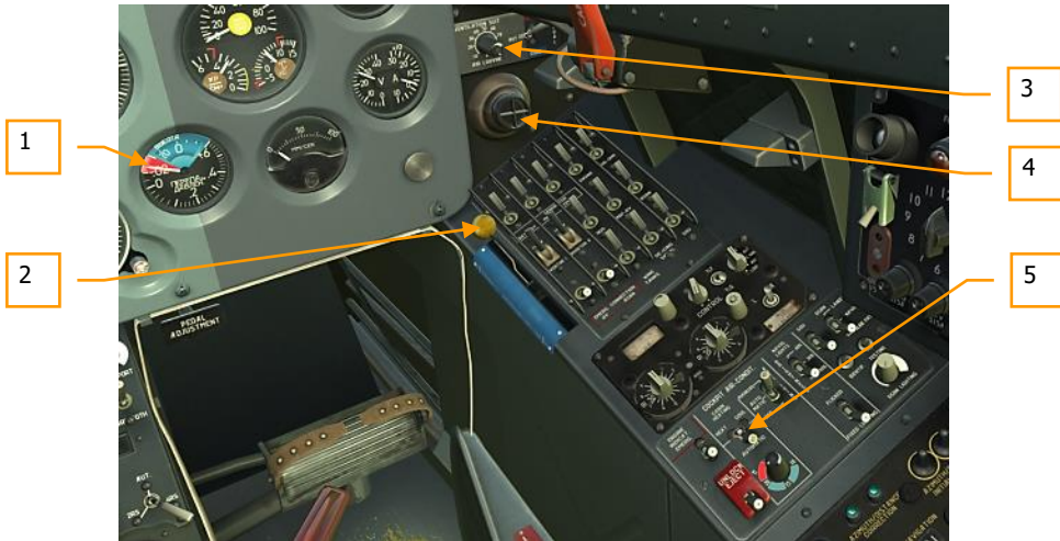
Abbildung 61: Das Belüftung- und Umgebungskontrollsystem und deren Anzeigen im vorderen Cockpit61
