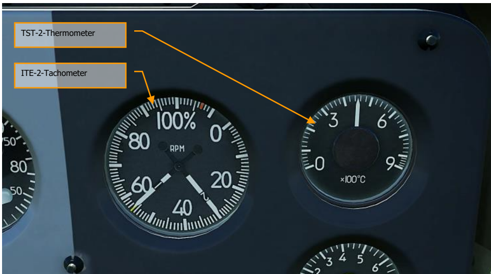
Abbildung 81: ITE-2-Tachometer und TST-2-Thermometer81
