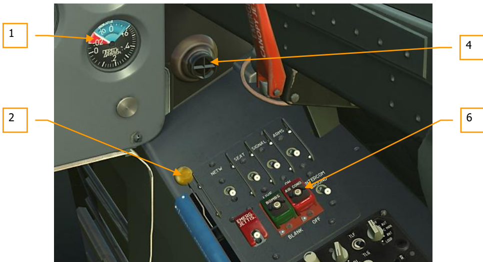
Abbildung 62: Das Belüftung- und Umgebungskontrollsystem und deren Anzeigen im hinteren Cockpit62
