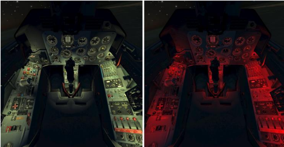
Abbildung 92: Weiße und rote Cockpit-Beleuchtung im vorderen Cockpit92
