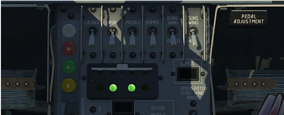
Abbildung 173: Anzeige für Außenlaststationen
