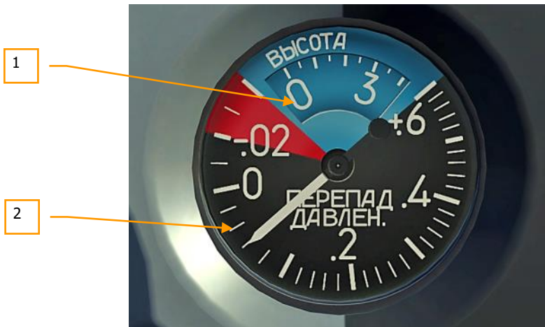
Abbildung 110: UVPD-Differenzanzeige für Höhe und Luftdruck
