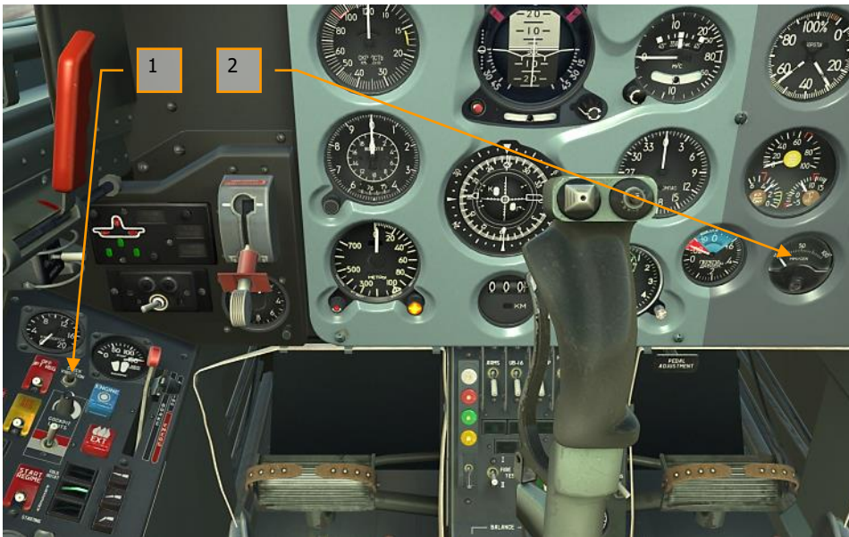
Abbildung 72: Vibration-Testknopf und Anzeige72
