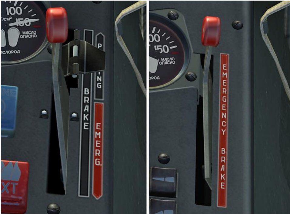
Abbildung 55: Notbremshebel im vorderen und hinteren Cockpit55
