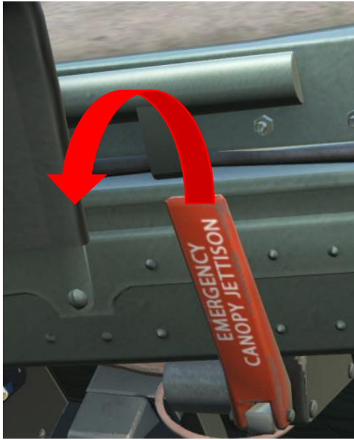
Abbildung 43: Hebel für Haubennotabwurf43
