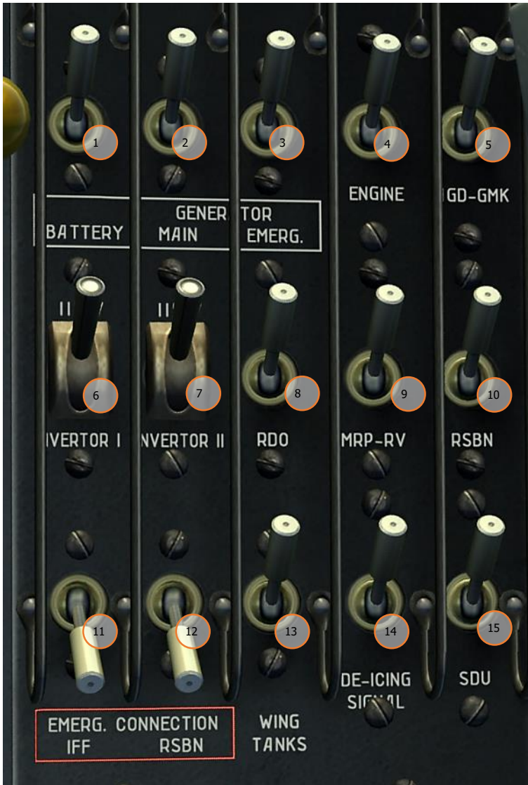
Abbildung 84: Hauptschalterfeld, vorderes Cockpit84
