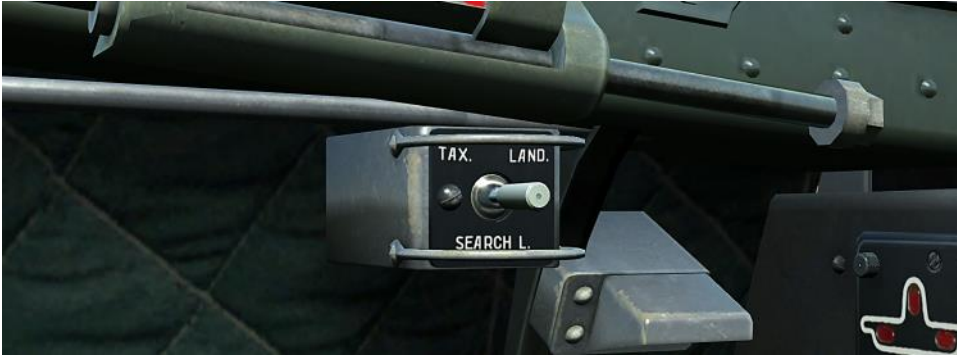
Abbildung 90: Schalter für Lande- und Rolleuchten 90
