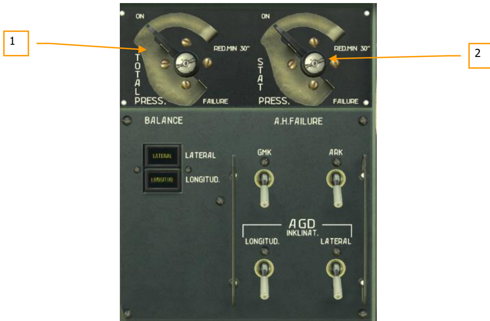
Abbildung 108: Bedienfeld für die Fehlersimulation der Instrumente im vorderen Cockpit108
