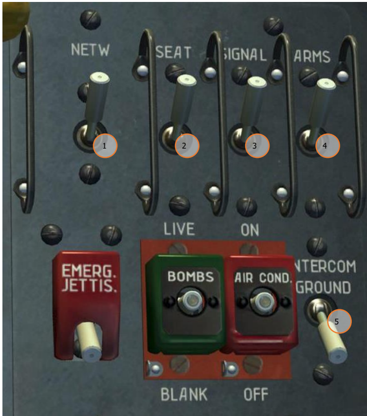
Abbildung 86: Hauptschalterfeld im hinteren Cockpit 86
