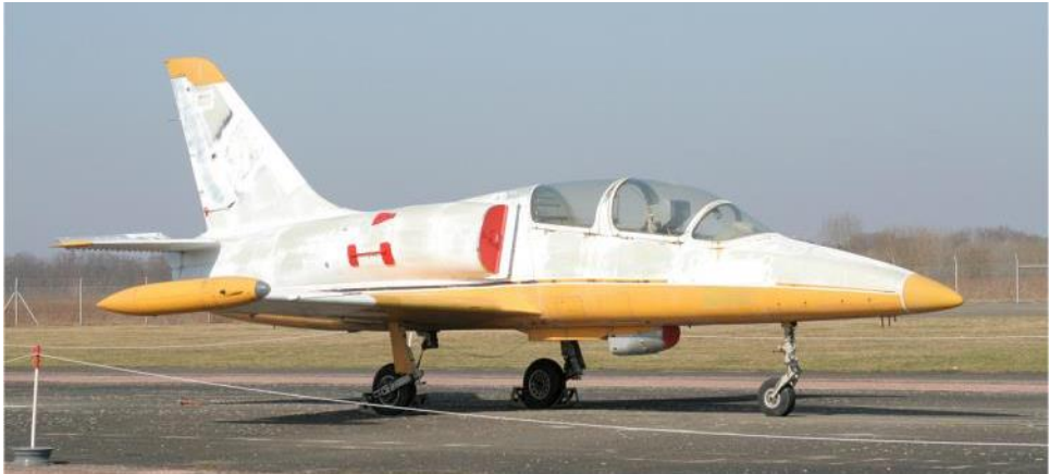
Abbildung 11: L-39V (Vlečná - Schlepper) – Einsitziger Zielschlepper für das Luftziel KT-0411
