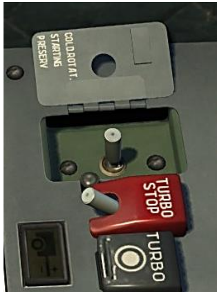
Abbildung 170: Der Startmodus-Schalter: PRESERV -STARTING -COLD. ROTAT170
