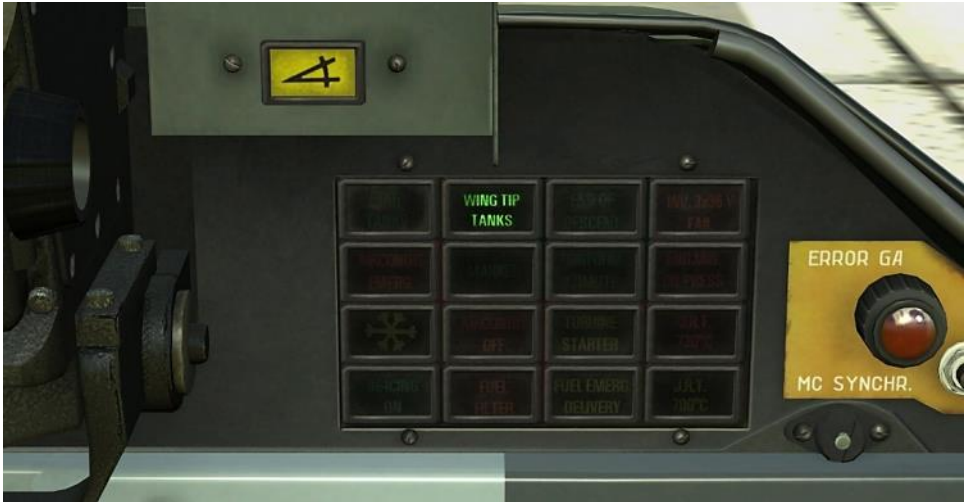
Abbildung 175: Die Leuchte: WING TIP TANKS auf dem Signalleuchtenfeld175
