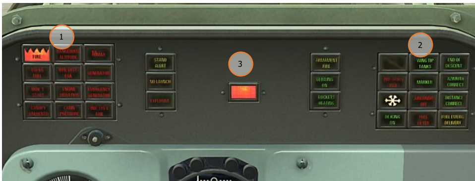
Abbildung 96: Warnleuchten und Gefahr- & Hinweisleuchtenfelder im vorderen Cockpit
