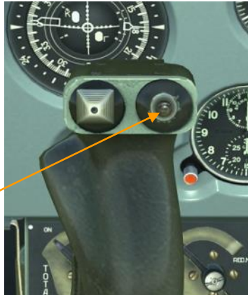
Abbildung 130 "INTERCOM"-Knopf am Steuerknüppel im hinteren Cockpit
