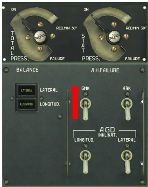
Abbildung 123: Die Bedienung des Fehlersimulators: GMK-1AE123
