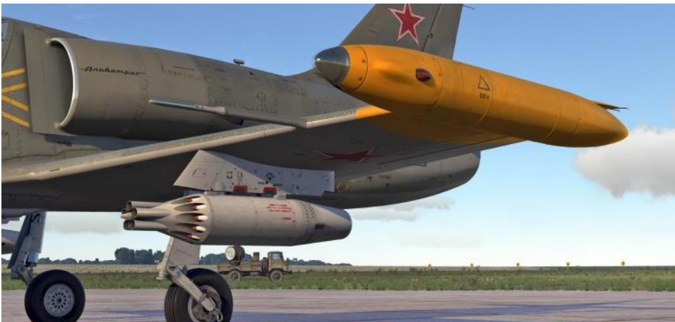
Abbildung 38: Pylon, Pitotrohr und Flügelspitzentank38
