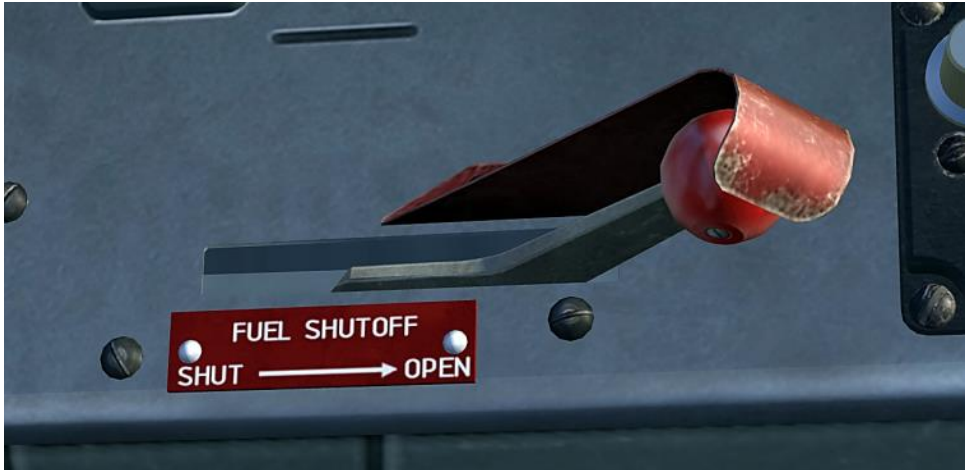
Abbildung 64: Der Brandhahn, wie er in beiden Cockpits zu finden ist64
