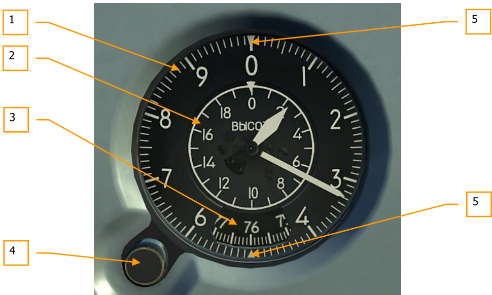
Abbildung 109: VD-20 Barometrischer Höhenmesser
