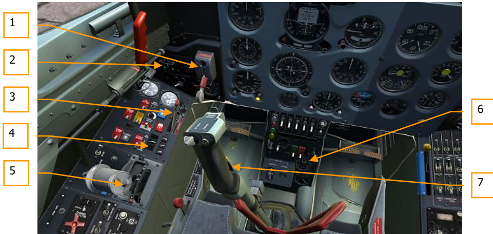
Abbildung 50: Die Bedienungen und Signalleuchten des Haupthdrauliksystems im vorderen Cockpit
