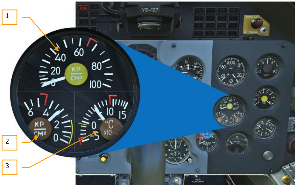
Abbildung 74: Kombiinstrument mit drei Zeiger74
