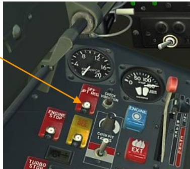
Abbildung 75: RT-12 Schalter für die manuelle Abschaltung des Reglers
