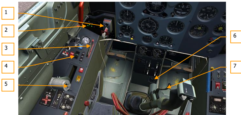
Abbildung 51: Die Bedienungen und Signalleuchten des Haupthdrauliksystems im hinteren Cockpit
