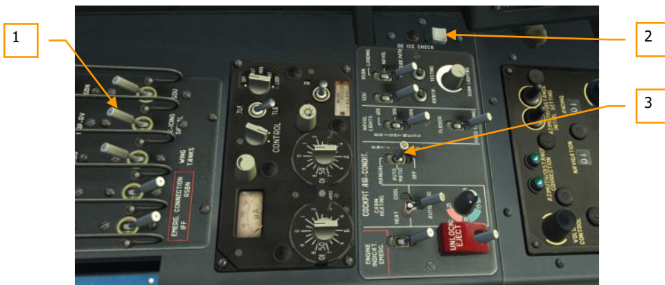
Abbildung 70: Bedienelemente des Vereisungsschutzsystem70
