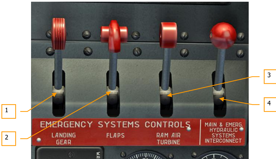
Abbildung 53: Hähne für das Notfallhydrauliksystem
