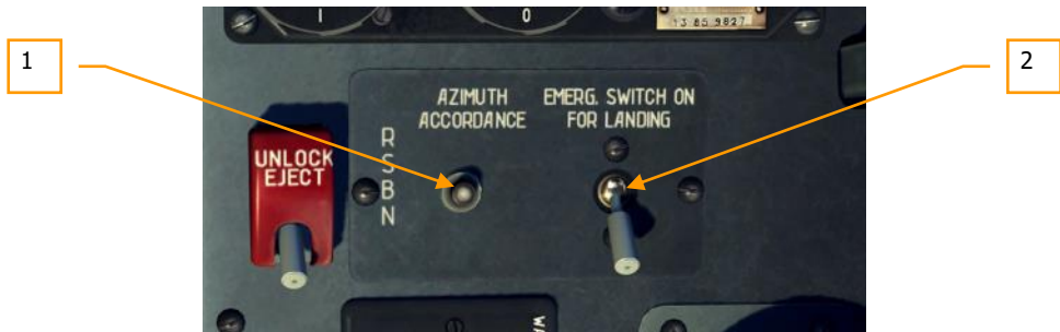
Abbildung 139: RSBN-5S-Steuerung im hinteren Cockpit139
