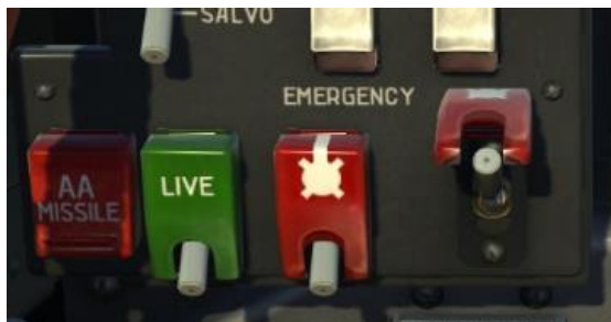
Abbildung 177: Der Not-Abwurfschalter im vorderen Cockpit177
