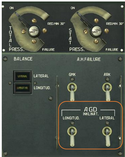
Abbildung 114: Bedienelemente für die Fehlersimulation des ADI114
